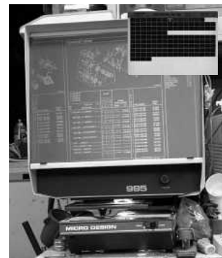
Fig 6.48 A microfiche reader with microfiche card inset.
